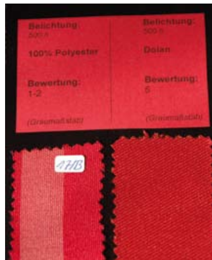
Im Dauertest unter der Xenon-Lampe wird die Leistungsfähigkeit eines Stoffes deutlich. Im linken Gewebe kann man deutlich „Sonneschäden“ erkennen.
