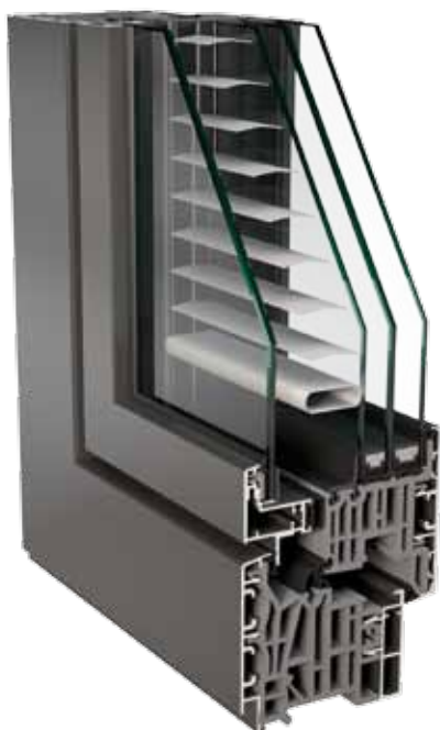
Mit einer zwischen den Scheiben integrierten Jalousette sind sowohl Wärmeschutz und Schallschutz als auch Sicht- und Sonnenschutz in einem einzigen Fensterflügel vereint.
